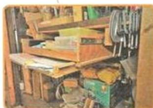
上段の引き出しにスライドレールを使用。下段はアングルを使っている
